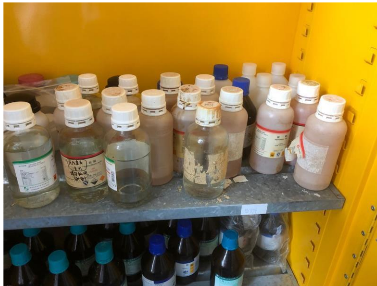
危化品柜内试剂标签已腐蚀
