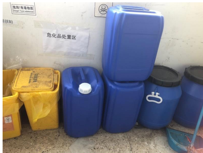
未设置废弃物临时存放区警示带 废液桶叠放, 无二次防泄漏托盘
