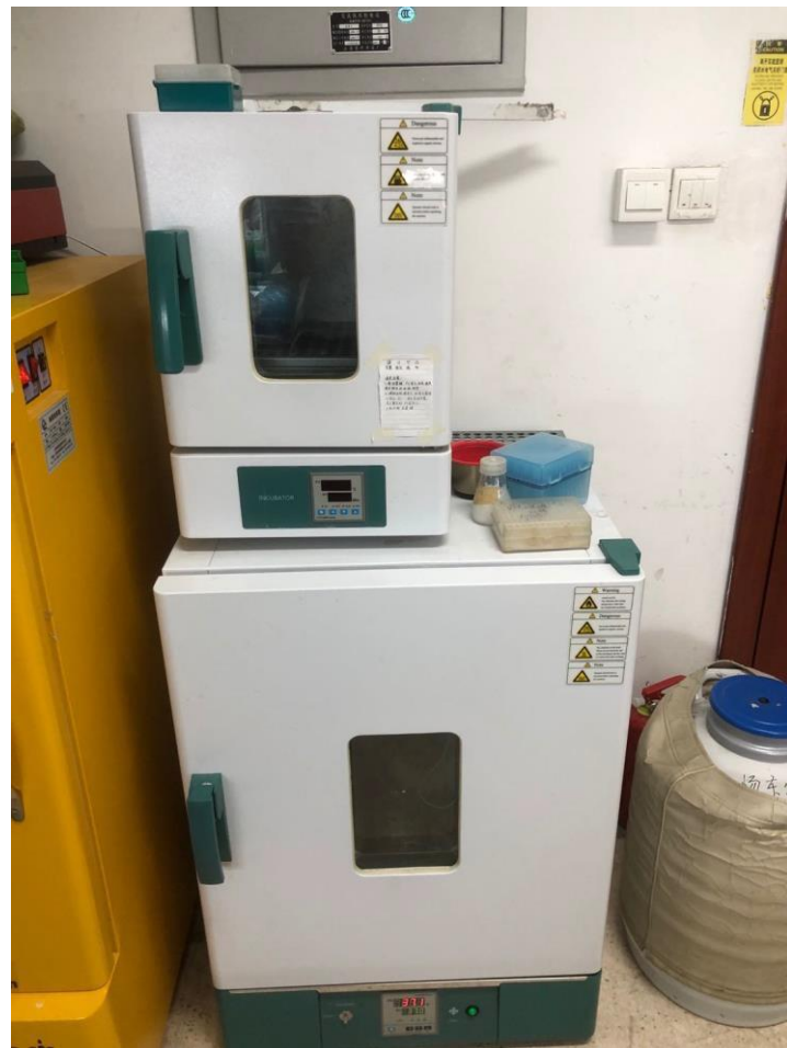
烘箱上堆放仪器 液氮罐未见安全警示标识和警戒线
