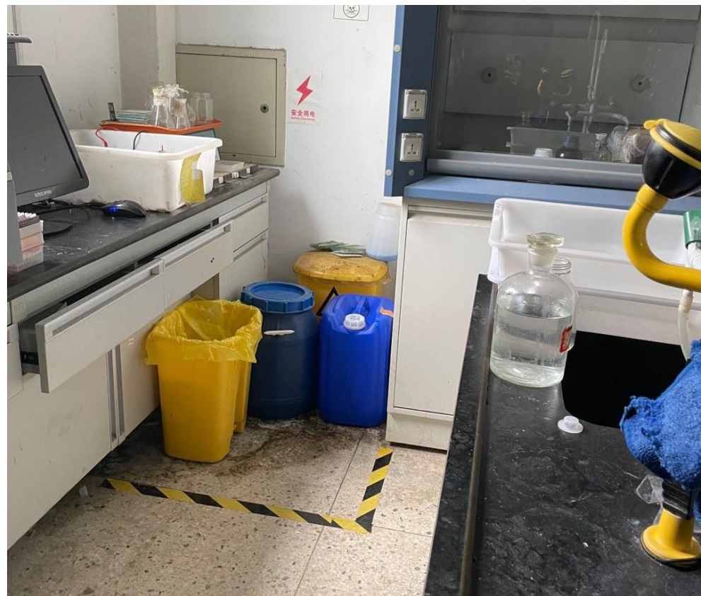
废液桶无二次防泄漏托盘
