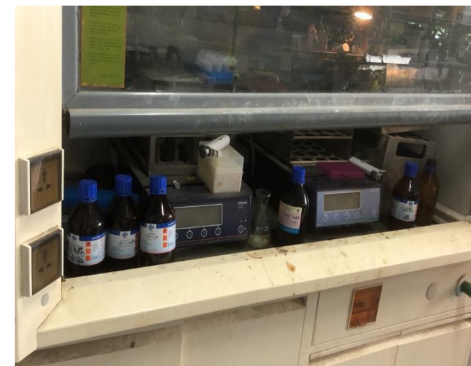
通风橱堆积杂物 玻璃视窗未关
