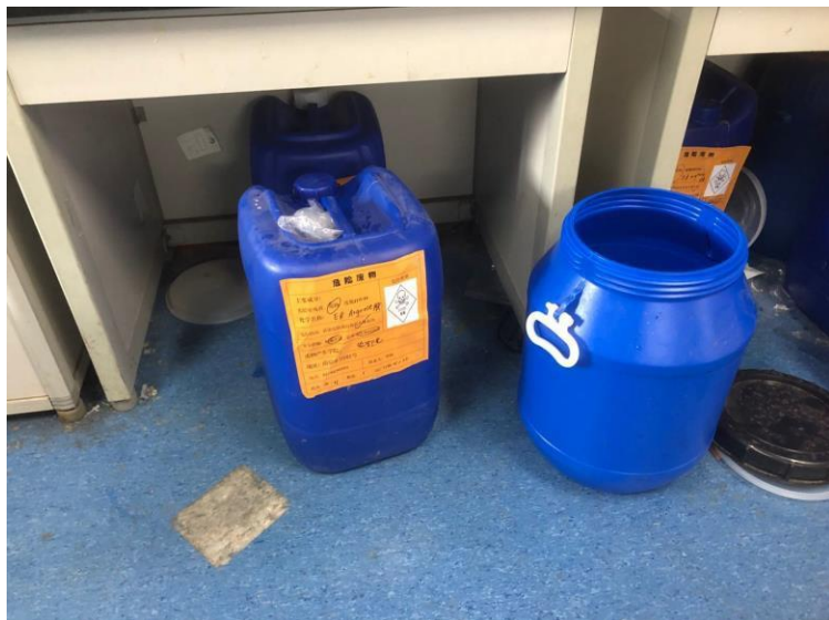
未明确标识、划定废弃区收集区域 废胶桶未盖盖子 废液桶无二次防泄漏托盘
