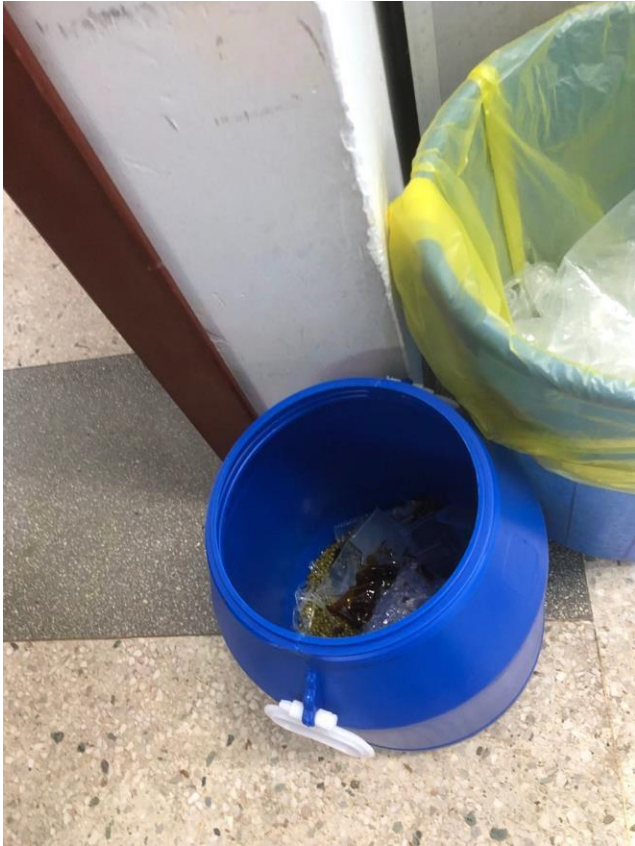
未明确标识、划定废弃区收集区域 废胶桶未盖盖子, 废液桶无二次防泄漏托盘
