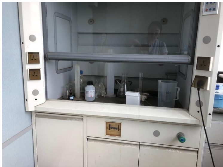
通风橱堆积杂物 玻璃视窗未关
