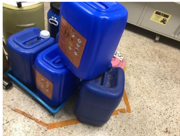
废液桶叠放, 无二次防泄漏托盘
