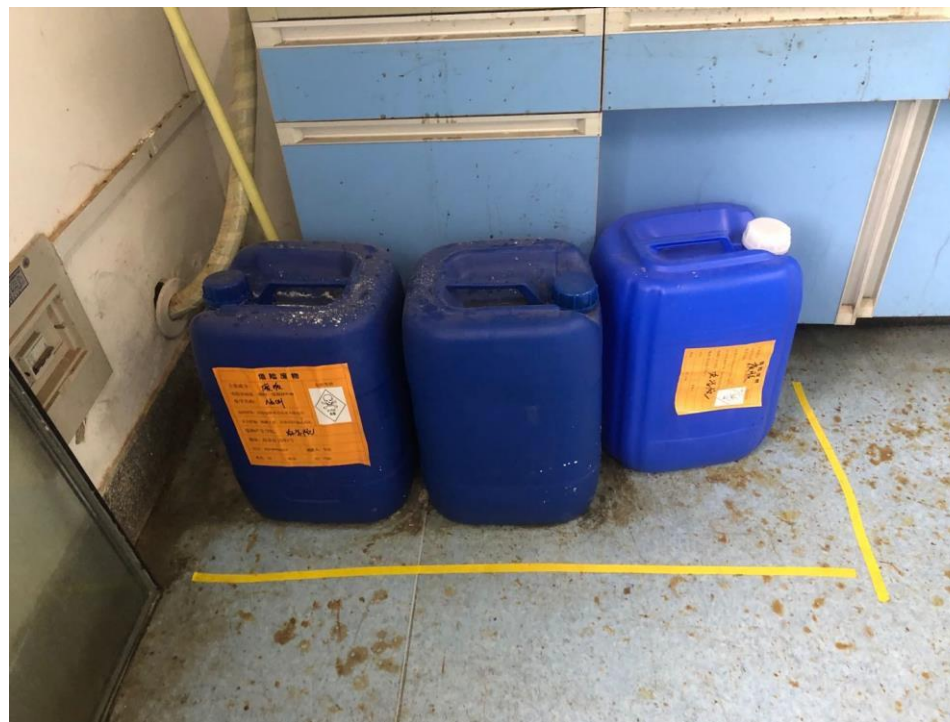
废液桶无二次防泄漏托盘
