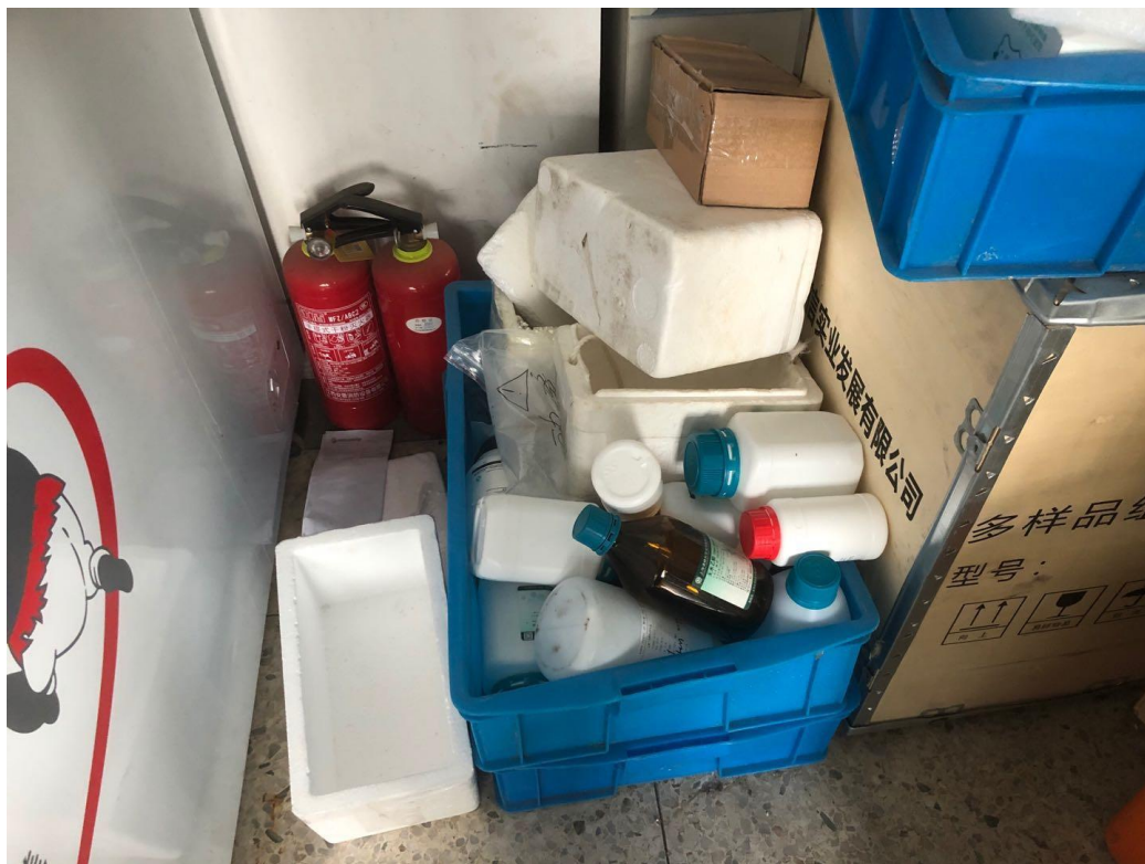
未明确标识、划定废弃区收集区域 试剂空瓶未按要求存放 灭火器放置无灭火器架
